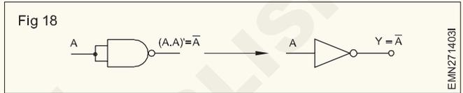
NAND গেট এবং গেট হিসাবে বাস্তবায়িত। চিত্র 19-এ দেখানো হিসাবে NAND গেট দ্বারা একটি AND গেট প্রয়োগ করা যেতে পারে। (AND একটি NAND গেট দ্বারা প্রতিস্থাপিত হয় এবং এর আউটপুট একটি NAND গেট ইনভার্টার দ্বারা পরিপূরক হয়)।
